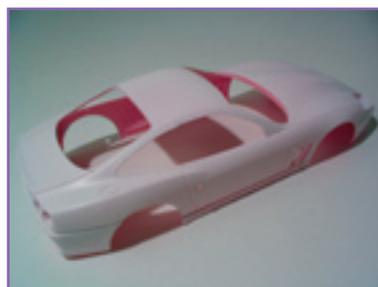
Juste avant de peindre, la carrosserie est frottée avec un chiffon doux pour éliminer les poussières de ponçage, on peut également la repasser sous l'eau avec du liquide vaisselle mais il faudra
