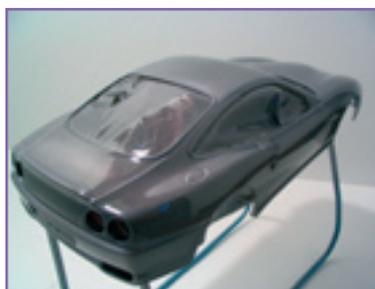
Deux couches épaisses de vernis sont passées à 5 / 10 minutes d'intervalle, deux couches mouillées. Ces deux couches donneront le brillant et la profondeur finale à la carrosserie
